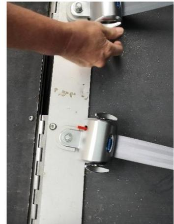
12. Gurte mittels Drehvorrichtung spannen
