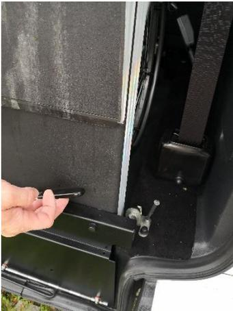
1. Zum Herunterfahren der Rampe Arretierung lösen
