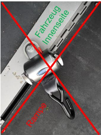
4. Befestigungsvorrichtung muss sich immer auf der Fahrzeug Innenseite befinden!
